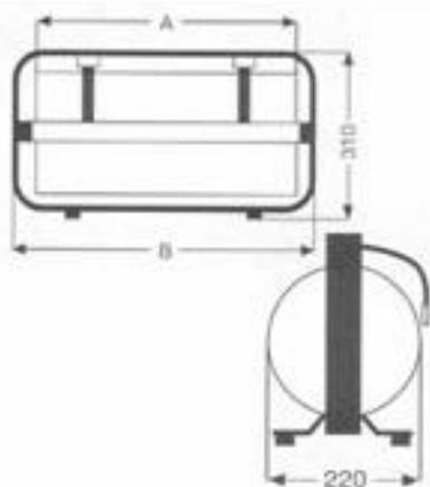
Portarrollos para rollos de papel de envolver estándar de hasta 1000mm de ancho. Fijación mediante tornillos a superficie de mostrador. Marco en perfil de acero, cuchilla plana para papel ó dentada para papel y plastificados. Suministrable para los siguientes anchos de rollo: 300mm, 400mm, 500mm, 600mm, 750mm, 800mm y 1000mm.
