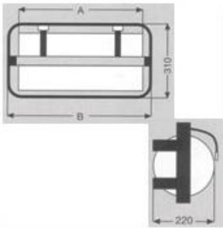
Portarrollos para rollos de papel de envolver estándar de hasta 1000mm de ancho. Fijación mediante tornillos a la pared (superficie vertical). Marco en perfil de acero, cuchilla plana para papel ó dentada para papel y plastificados. Suministrable para los siguientes anchos de rollo: 300mm, 400mm, 500mm, 600mm, 750mm, 800mm y 1000mm.
