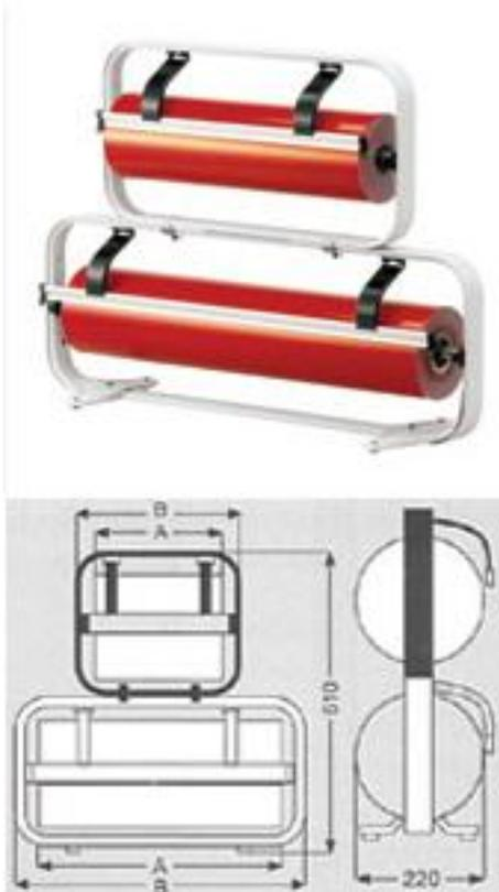
Portarrollos suplementario para rollos de papel de envolver estándar de hasta 1000mm de ancho. Fijación sobre otro portarrollos de mesa ó pared. Marco en perfil de acero, cuchilla plana para papel ó dentada para papel y plastificados. Suministrable para los siguientes anchos de rollo: 300mm, 400mm, 500mm, 600mm, 750mm, 800mm y 1000mm.
