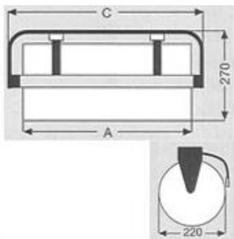
Portarrollos para rollos de papel de envolver estándar de hasta 1000mm de ancho. Fijación mediante tornillos bajo mostrador. Marco en perfil de acero, cuchilla plana para papel ó dentada para papel y plastificados. Suministrable para los siguientes anchos de rollo: 300mm, 400mm, 500mm, 600mm, 750mm, 800mm y 1000mm.
