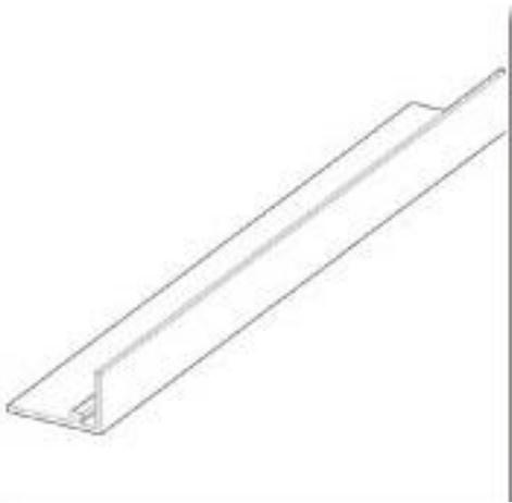
Guía en "T" con frontal y banda autoadhesiva. El frontal de 30mm de alto evita la caída accidental de productos. Se presenta en cajas de 50 unidades cortados a 1000mm ó 1250mm.
